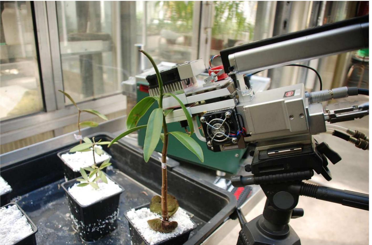
IRGA (Analizador de Gases por Infrarrojo) midiendo un mangle en laboratorio.
